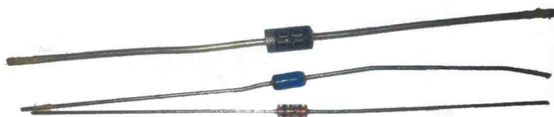
Figura 2.24. Representação fotográfica de alguns diodos. Fonte: elaborada pelo autor.
