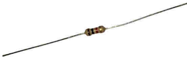
Figura 1.2. Foto de um resistor real. Fonte: elaborada pelo autor.
